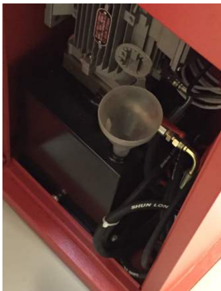
Fig. 14 - Påfyldning af hydraulikolie
