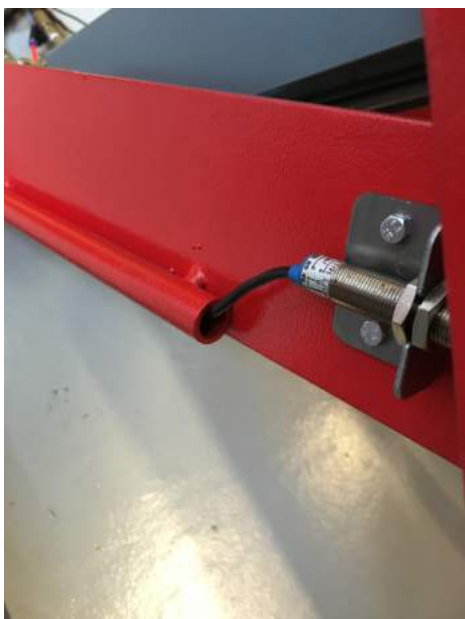
Fig. 8 - Montering af topsensor på autolift
