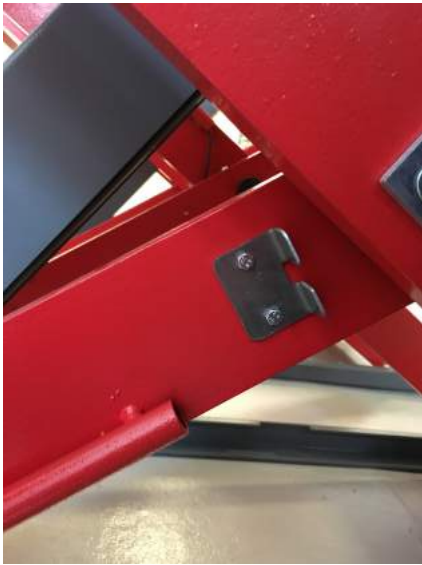
Fig. 5 – Montering af fodsensor beslag
