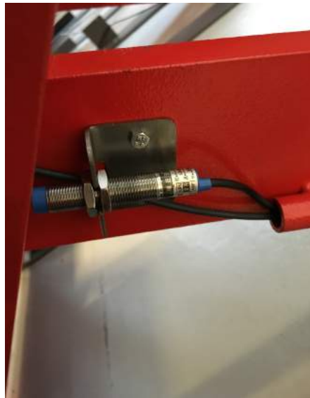
Fig. 6 – Montering af fodsensor
