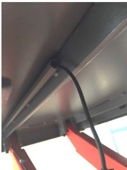
Fig. 10 + 11 - Føring af kabel til fotosensor.
