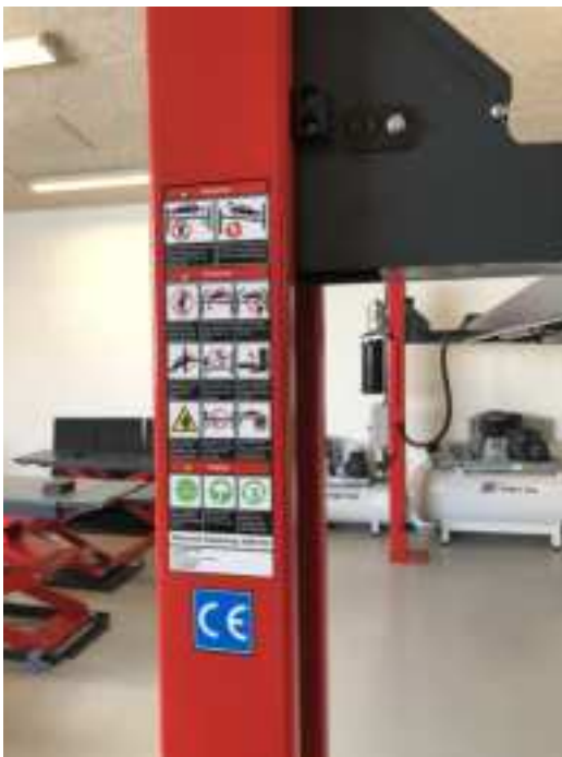
Fig. 1 - Placering af advarselsskilt på maskinen
